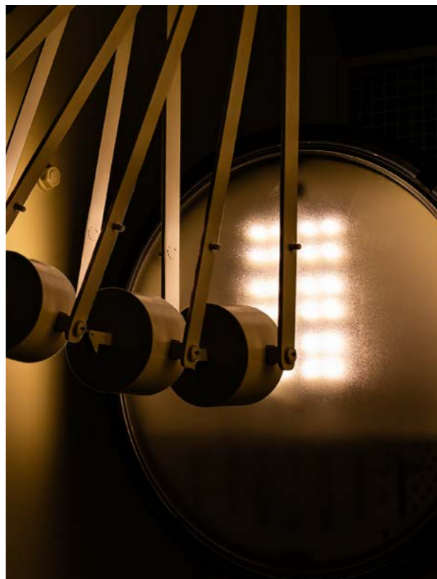
Ensayo ATP: impacto de 50 julios de energía con una maza de 5 kg.
