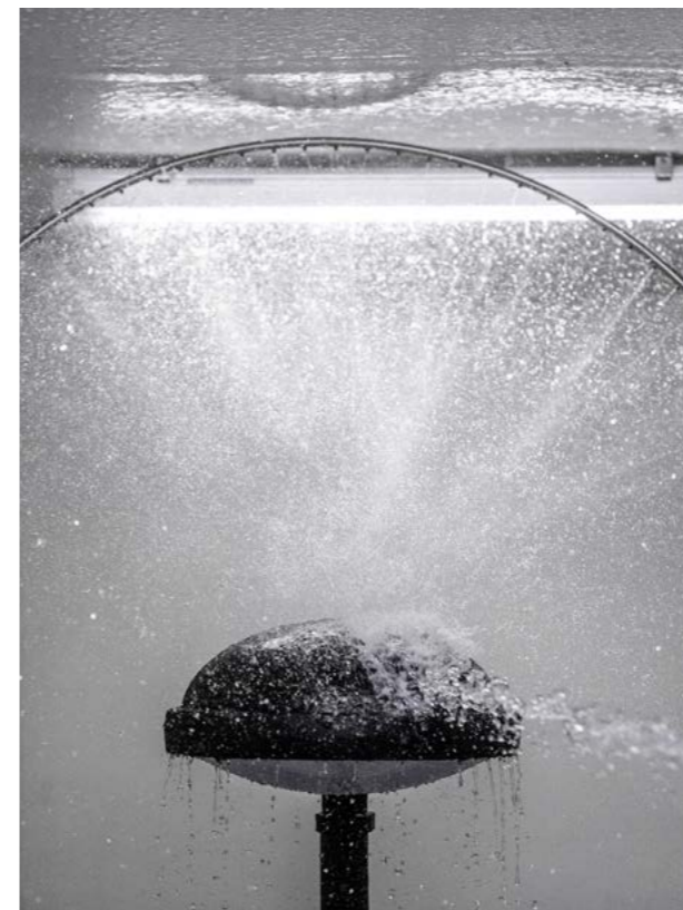
Ensayo ATP: proyección de agua desde todos los ángulos a un promedio de 100 l/min con una presión de 100 kN/m 2 .
