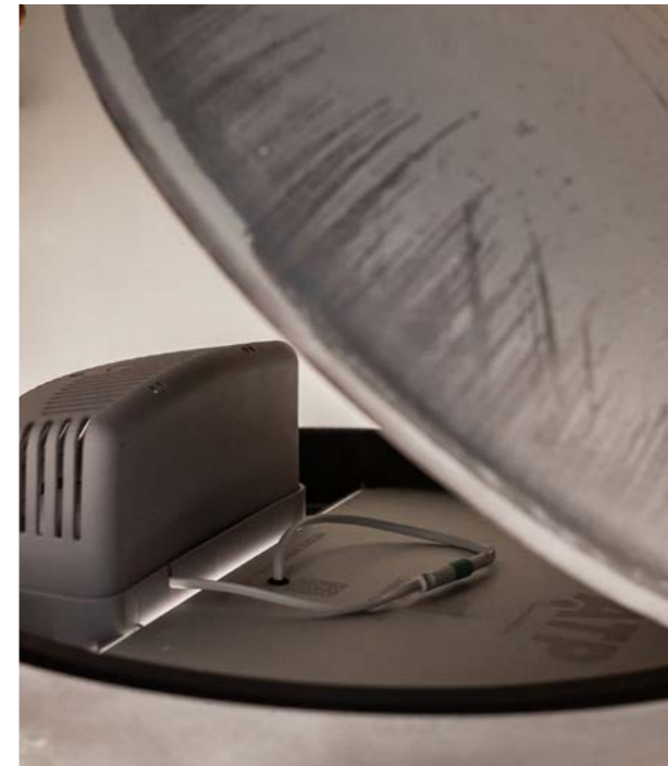
Ensayo ATP: nube en movimiento continuo de 2 kg/m 3 de polvo de diámetro inferior a 75 µm.
