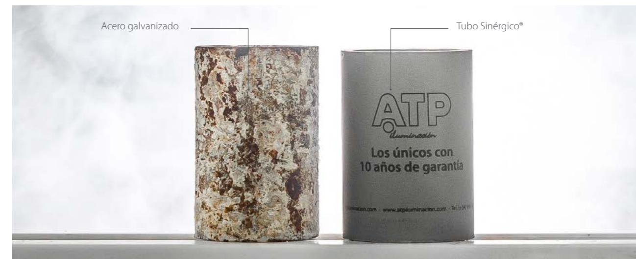
Sección de columna de acero galvanizado de otro fabricante y Tubo Sinérgico® de ATP, ambos tras 2000 horas de exposición en cámara de niebla salina.
